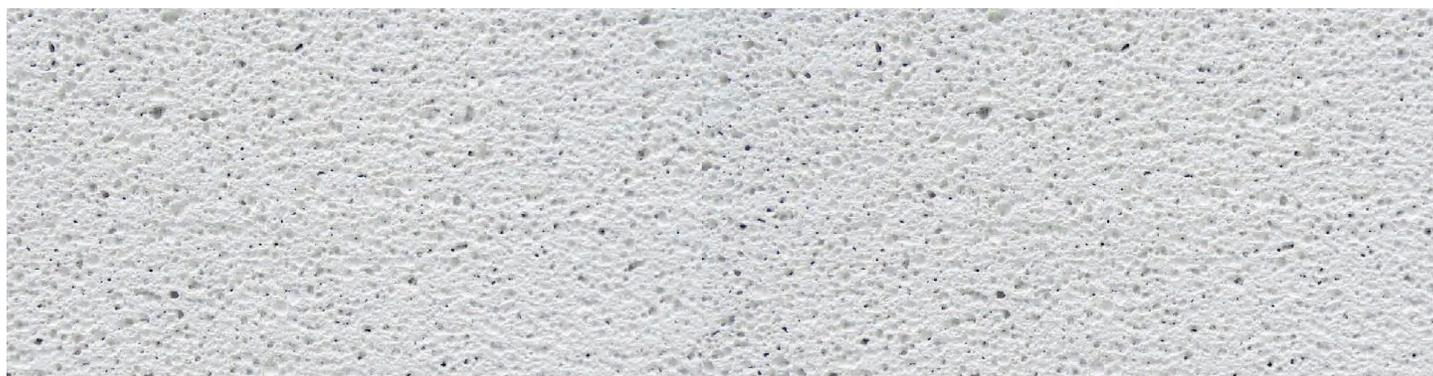
El **Celucemento** es un **concreto aireado autoclaveado (AAC)** que por sus propiedades es capaz de ofrecer ligereza y resistencia, además de ser ecológico ya que es producido con materiales naturales como: agua, cemento, arena sílica, cal y yeso. En su fabricación no se utiliza ningún tipo de plástico o concreto a base de foam. **Celucemento** está disponible en block y paneles prefabricados de diferentes dimensiones, ambos listos para crear fácilmente muros o paneles.
