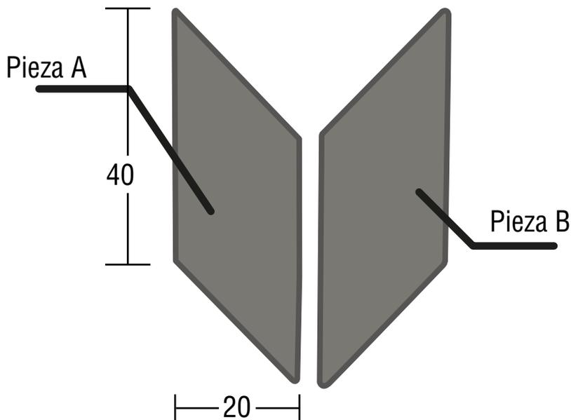
Módulo sólido de concreto vibrocompactado, utilizado para la construcción de sistemas de pavimentos flexibles.
