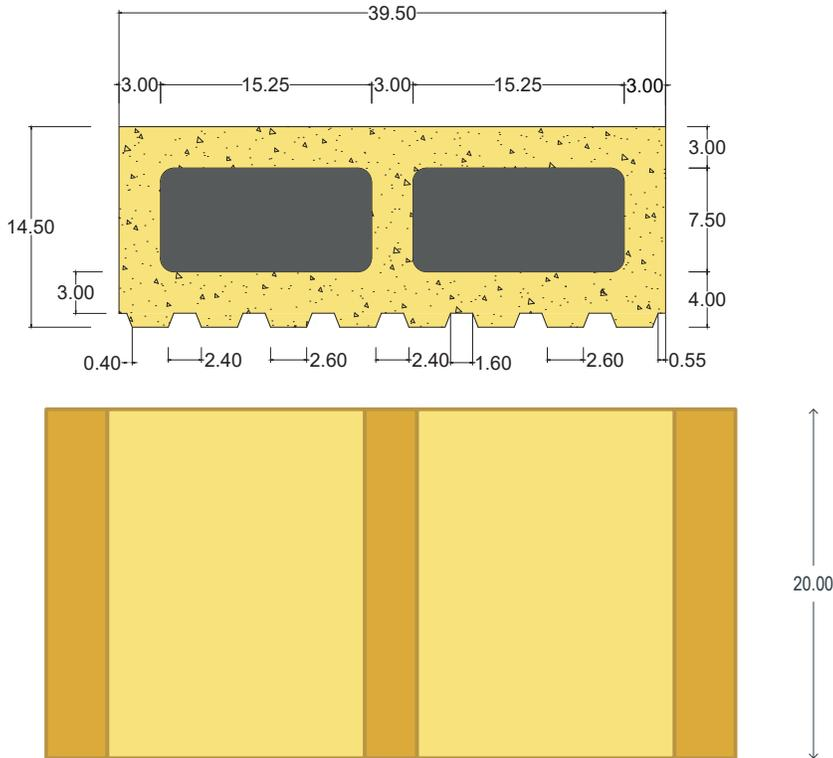
Módulo hueco de concreto vibrocompactado para la construcción de sistemas de muros.
