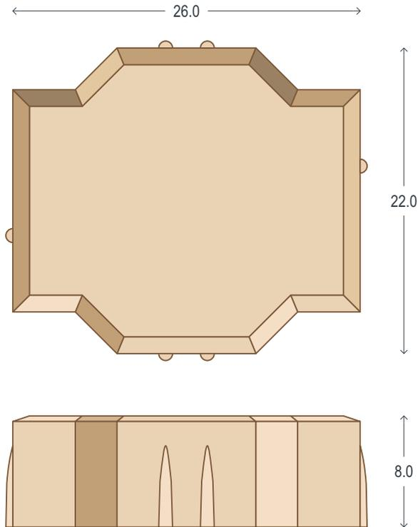
**Módulo sólido de concreto vibrocompactado, utilizado para la construcción de sistemas de pavimentos flexibles.**
