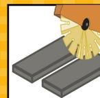
De ser necesario el corte, utilice disco para concreto
