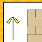
Estiba a 15 piezas de altura máxima, sobre superficie nivelada
