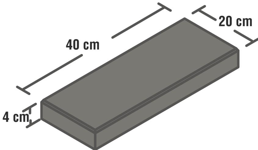
Pieza rectangular prefabricada de concreto con dimensiones de acuerdo a la figura.
