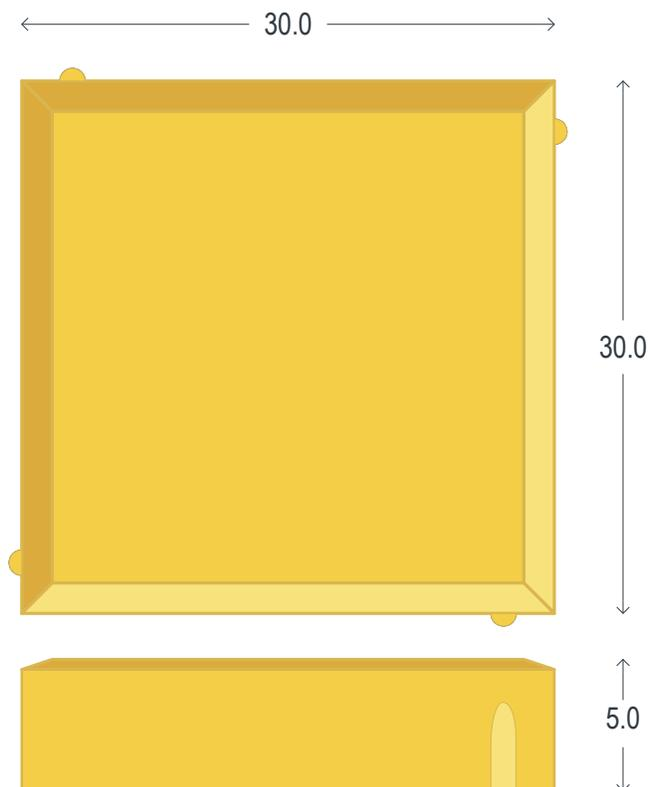
Módulo sólido de concreto simple vibrocompactado, utilizado para la construcción de sistemas de pavimentos semirígidos.
