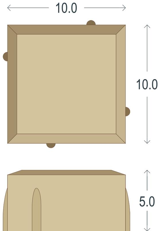
Módulo sólido de concreto simple vibrocompactado, utilizado para la construcción de sistemas de pavimentos semirígidos.
