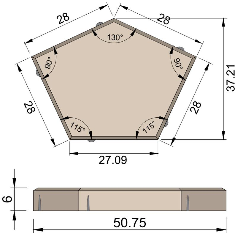
Pieza sólida de concreto arquitectónico, utilizada para la construcción de sistemas de pavimentos semirígidos.
