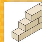
Rendimiento para un aparejo a soga:  $30.5 \text{ pz/m}^2$ . (Considerando una junta de  $5\text{mm}$ ).
