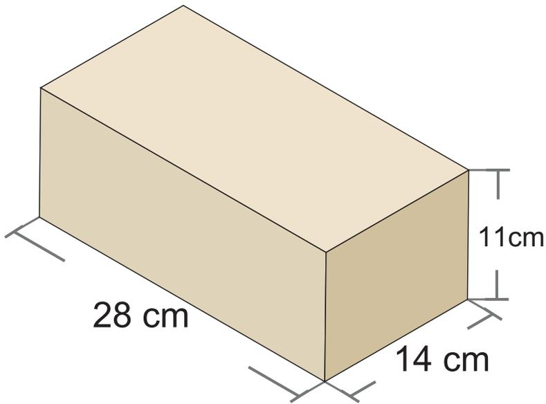
Módulo sólido de jalcreto vibrocompactado para la construcción de sistemas de muros.
