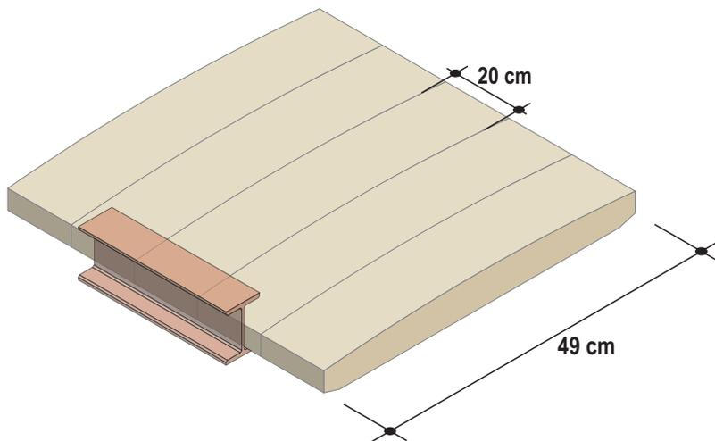
**INSTALACIÓN:** Una vez niveladas las dalas o el armado de éstas, marque 1 m de espaciamiento para colocar las vigas metálicas, una vez elevadas, sitúe una boveduca en cada extremo del claro a cubrir para corregir el espaciamiento, posteriormente rellene el espacio entre ambas. Tienda la malla electrosoldada y cuele 5 cm de concreto  $f'c = 200 \text{ kg/cm}^2$ .
