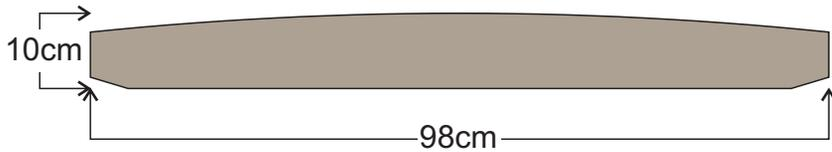
Módulo sólido prefabricado en jalcreto, con extremos laterales diseñados para sentar en el patín de una viga metálica; funciona como un aligerante del sistema y como cimbra para el concreto colado en obra.
