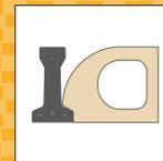
**Usos:** para instalarse con vigueta pretensada Napresa. (Otras secciones de concreto o acero generarán un desfase en el asiento de las piezas).
