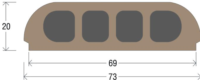
Módulo hueco prefabricado en jalcreto, cuya sección coincide con el patín inferior de la **vigueta T20**; funciona como una cimbra para la capa de compresión y aligerante de la losa.
