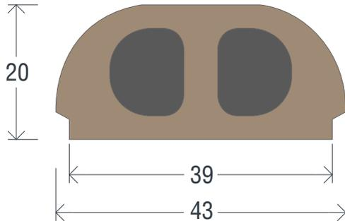
Módulo hueco prefabricado en jalcreto, cuya sección coincide con el patín inferior de la **vigueta T20**; funciona como una cimbra para la capa de compresión y aligerante de la losa.
