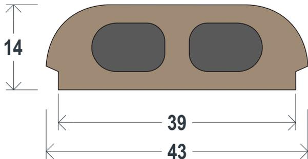
Módulo hueco prefabricado en jalcreto, cuya sección coincide con el patín inferior de la vigueta T15; funciona como una cimbra para la capa de compresión y aligerante de la losa.
