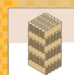
Estiba: induzca una trabazón entre piezas a una altura máxima de seis camas y sobre superficie nivelada.
