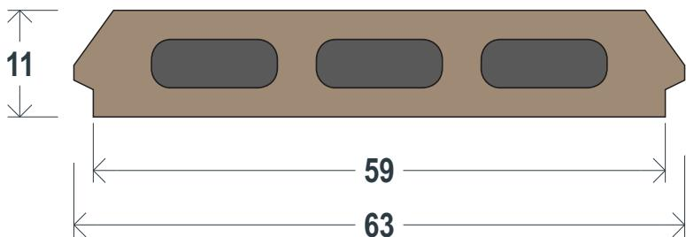
**Módulo hueco prefabricado en jalcreto**, cuya sección coincide con el patín inferior de la vigueta T11; funciona como una cimbra para la capa de compresión y aligerante de la losa.
