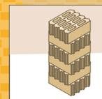
Estiba: induzca una trabazón entre piezas a una altura máxima de seis camas y sobre superficie nivelada.
