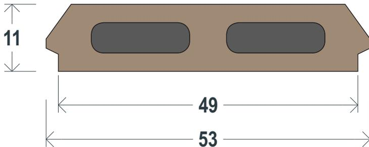
**Módulo hueco prefabricado en jalcreto, cuya sección coincide con el patín inferior de la vigueta T11; funciona como una cimbra para la capa de compresión y aligerante de la losa.**
